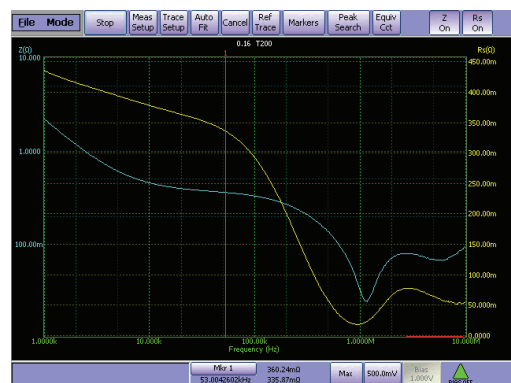
圖 3：82 \mu F/400V 電解電容並聯 1.5 \mu F/400V 塑膠膜電容 阻抗
